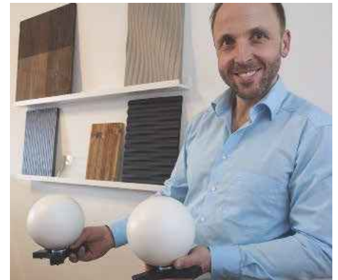
„Sind mehrere Scans nötig, werden Referenzkugeln ausgelegt, um sie später am PC zusammenzuführen.“
