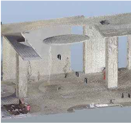
/ Je nach Größe und Aufteilung des Objektes werden mehrere Scans zu einer Punktwolke zusammengeführt.
